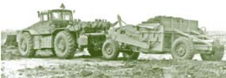
Фото 15. Инженерный колёсный тягач КЗКТ-538ДП (ИКТ) в составе агрегата БКТ-РК2. Работа с прицепным гидрофицированным скрепером
