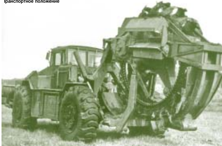
Фото 17. Инженерный колёсный тягач КЗКТ-538ДК (ИКТ) в составе траншейной машины ТМК-2. Машина в работе
