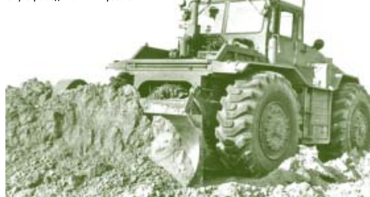
Фото 6. Инженерный колёсный тягач МАЗ-528 (ИКТ) с путеукладчиком ПКТ в работе
