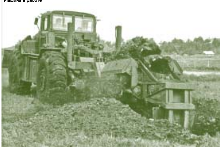
Фото 17. Инженерный колёсный тягач КЗКТ-538ДК (ИКТ) в составе траншейной машины ТМК-2. Машина в работе
