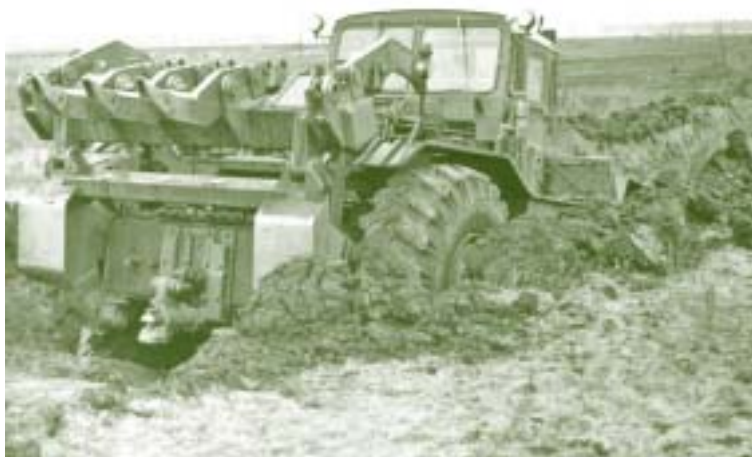
Фото 14. Инженерный колёсный тягач КЗКТ-538ДП (ИКТ) в составе агрегата БКТ-РК2. Работа рыхлительно-корчевальным оборудованием
