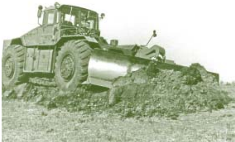
Фото 12. Инженерный колёсный тягач КЗКТ-538ДП (ИКТ) в составе путепрокладчика ПКТ-2. Рабочий орган установлен в грейдерное положение
