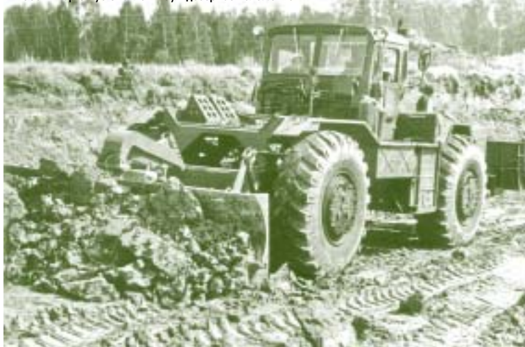
Фото 12. Инженерный колёсный тягач КЗКТ-538ДП (ИКТ) в составе путепрокладчика ПКТ-2. Рабочий орган установлен в грейдерное положение
