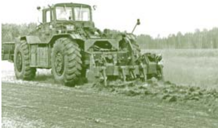
Фото 14. Инженерный колёсный тягач КЗКТ-538ДП (ИКТ) в составе агрегата БКТ-РК2. Работа рыхлительно-корчевальным оборудованием
